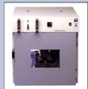
Ensayo de Envejecimiento con Cilindro Rotativo (©BRRC)
