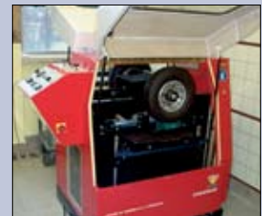
Ensayo de Deformación en Pista (©BRRC)
