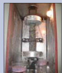
Ensayo de Espécimen Restringido de Tensión Térmica (©BRRC)
