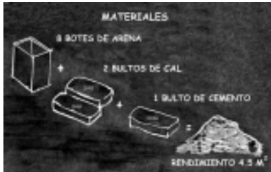
Foto 21. Proporciones para preparar la mezcla.
