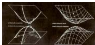
Foto 9. Malla suspendida. Tomada del libro de Heino Engel, Sistemas de estructuras , España, Editorial Gustavo Gili, 2002. p. 127
