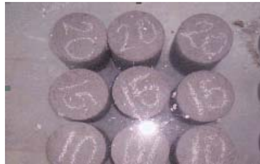
Fig. 1. Especímenes de concreto sumergido en agua (curado)
