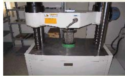
Fig. 2. Determinación de la resistencia a compresión del cilindro.
