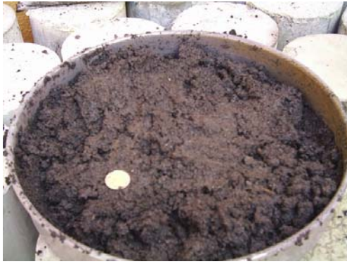
Figura 4. Consistencia de la mezcla suelo-cal 8% con la adición de un contenido de humedad del 55.2 %.
