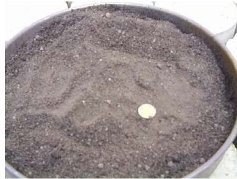
Figura 3. Consistencia de la mezcla suelo-cal 8% con la adición del primer contenido de humedad (18.5 %).
